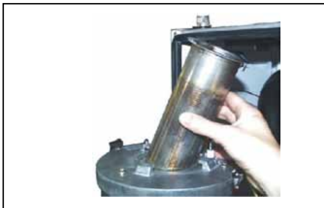
Εικόνα 4: Βγάλσιμο του καυστήρα
